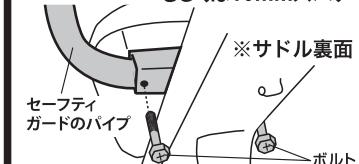
サドル裏のセーフティガードのパイプを固定しているボルト2本をはずし、パイプを上へ抜いてセーフティガード全体を取り外してください。
