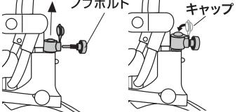
ノブボルトを抜き押棒を抜いてください。
