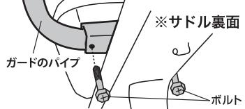
サドル裏のガードのパイプを固定しているボルト2本をはずし、パイプを上へ抜いてガード全体を取り外してください。
