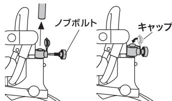
ノブボルトを抜き押棒を抜いてください。
