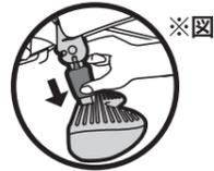
図のようにストッパーを持ち、①矢印方向に下ろしながら、ステップを②の方向にスライドさせるとたためます。(ステップを出す場合は逆の手順です。)
